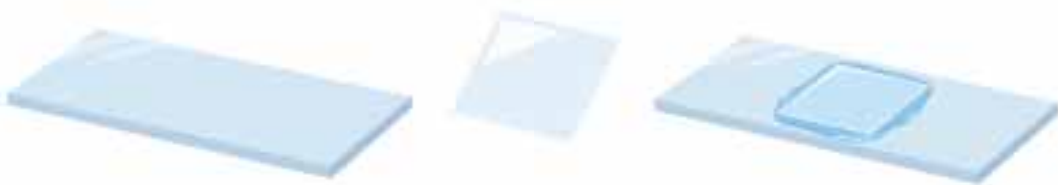
Предметно стакло, покровно стакло и готов нативни препарат
